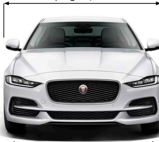
Spurweite vorn: RWD - 1.604,6 mm
